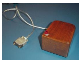
Prototyp myszy z 1964 r., wykonany wg projektu Douglasa C. Engelbarta
