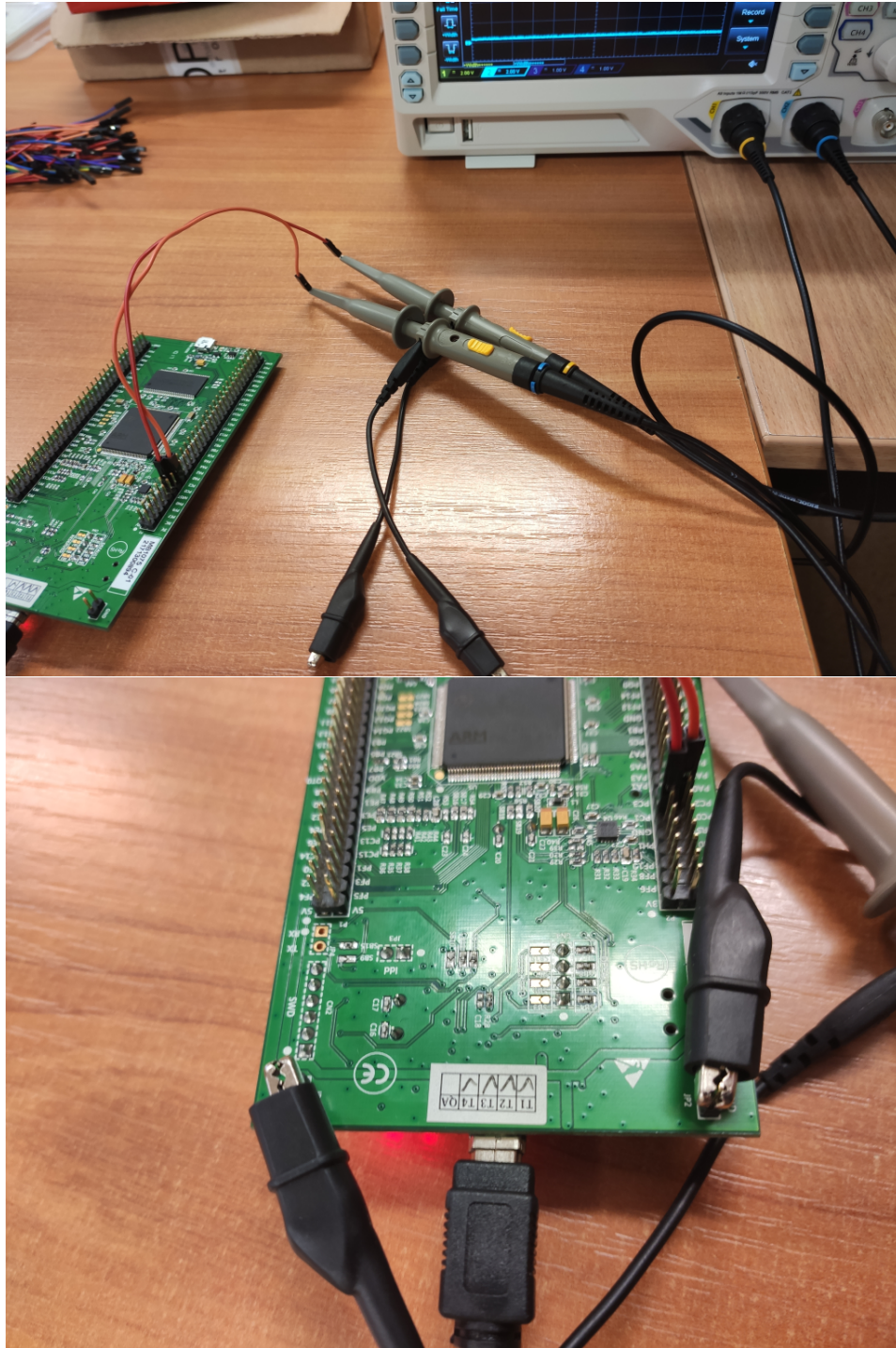
Rysunek 3.5: Podłączenie badanych sygnałów do sond i oscyloskopu
