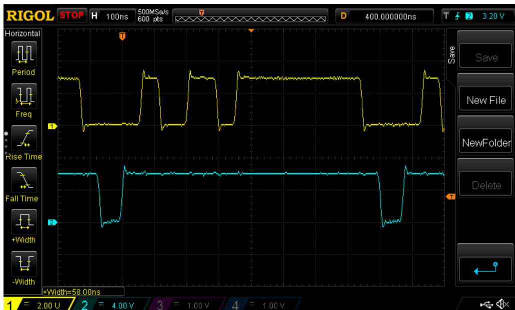
Rysunek 3.7: Konfiguracja oscyloskopu umożliwiająca pomiar szerokości generowanych impulsów
