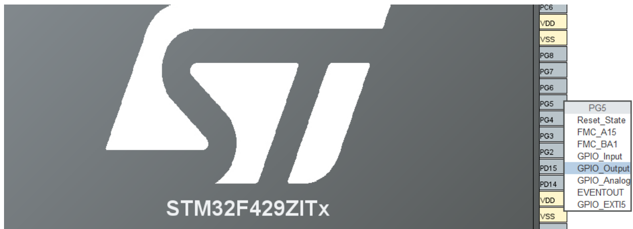
Rysunek 1.6: Konfiguracja pinu PG5 - STM32CubeMX
