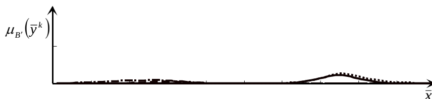
Rys. 6.12. Wykres sygnałów przekazywanych na warstwę wyodrębniającą w rozszerzonym systemie rozmyto-neuronowym z wnioskowaniem wg reguły ograniczonej sumy.
